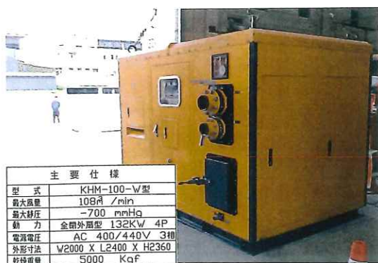
写真-1 吸泥排土装置 132kW
