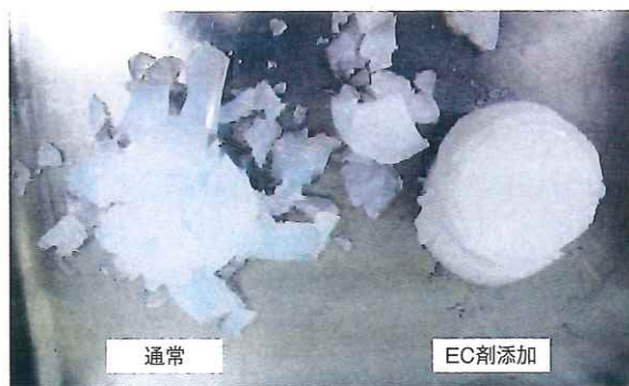
写真-5 弾性可塑剤を鉛直的に圧縮した状況
