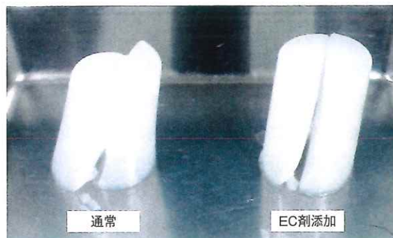
写真-6 弾性可塑剤を中央で切断した状況
